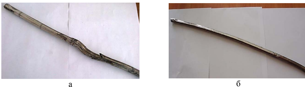
Рис. 3. Заготовки, полученные прямой (а) и комбинированной (б) экструзией
